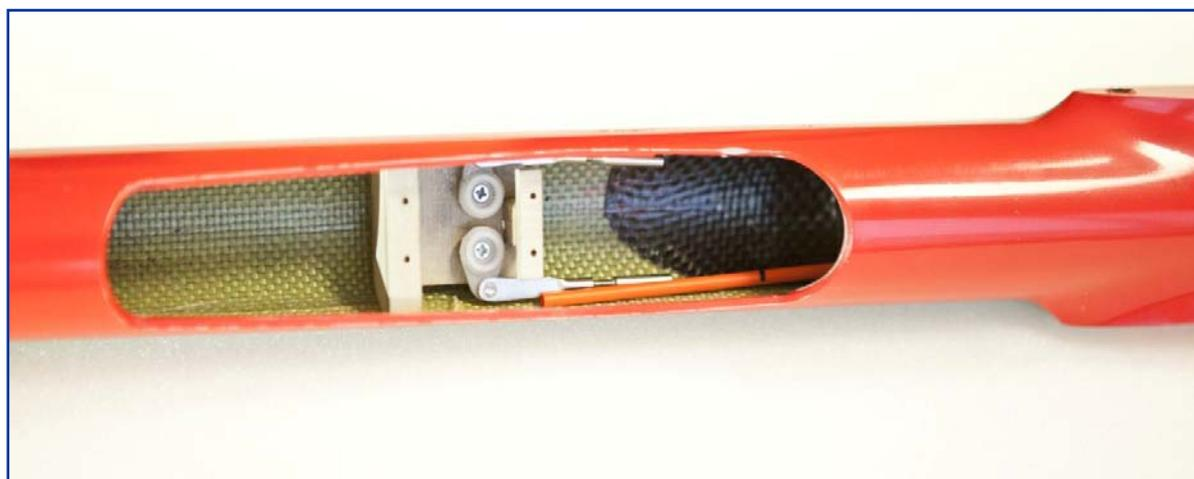
Рис.13 – Вклейка рамы в фюзеляж
