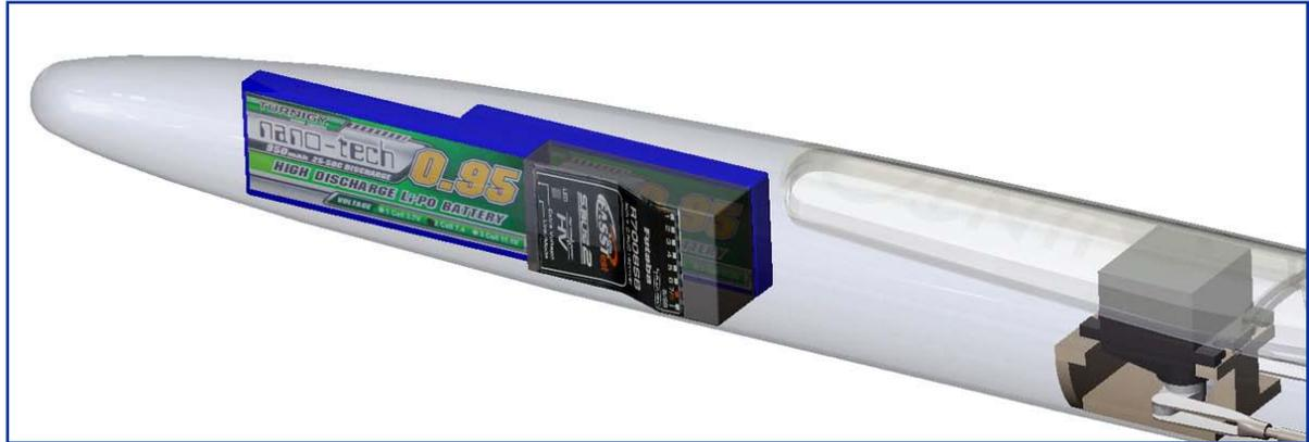
Рис.8 – Рекомендуемое расположение LDS рамы в фюзеляже Shinto
