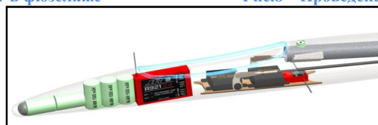
Рис.7 – Проклейка тяг в фюзеляже
