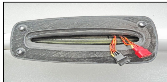
Рис.8 – Проведенные провода для крыла
