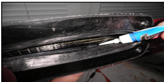
Рис.7 – Проклейка тяг в фюзеляже
