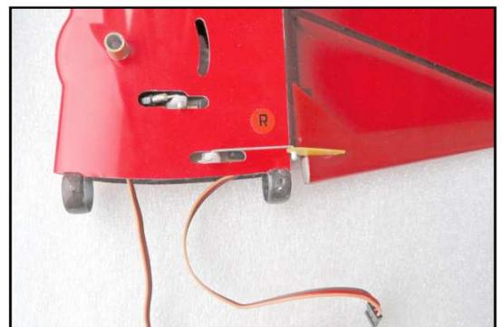
Рис.8 – Тяги хвостового оперения
