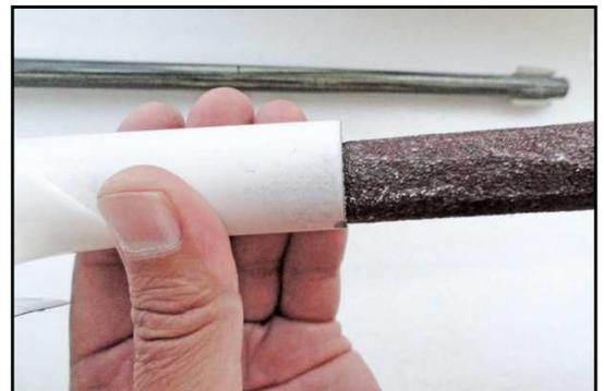
Рис.1 – Прошкуренный фюзеляж
