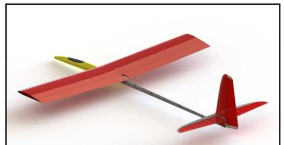
Рис.4 – Установленные центроплан и стабилизатор
