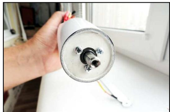
Рис.12 – Установленный двигатель в фюзеляж
