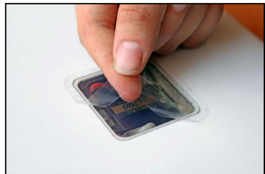
Рис.15 – Заклейка плоского лючка фиксатором
