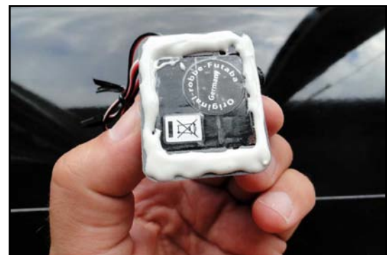
Рис.12 – Смолa на рамке сервомеханизма
