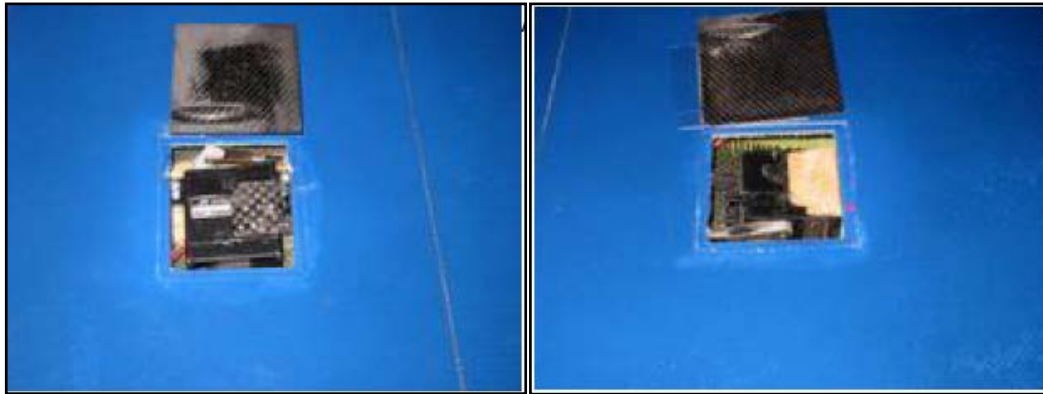
Рис.14 – Сервомеханизмы, связанные с верхней обшивкой крыла
