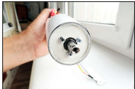
Рис.12 – Установленный двигатель в фюзеляж
