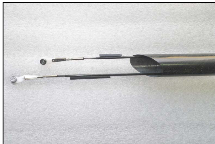
Рис.4 – Вклейка бальзовой фанеры для фиксации трубок тяг к фюзеляжу
