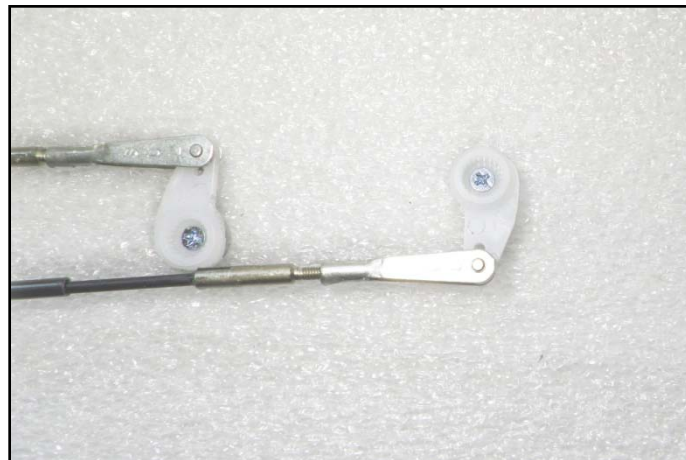
Рис.3 – Вклейка наконечников и кабанчиков тяг оперения
