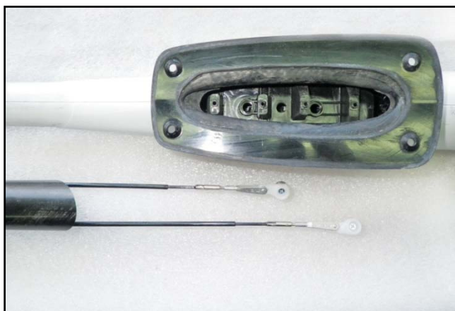
Рис.2 – Подготовка фюзеляжа для установки платформы машинок
