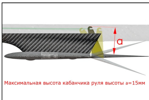
Рис.2.3 – Максимальная высота кабанчика руля высоты
