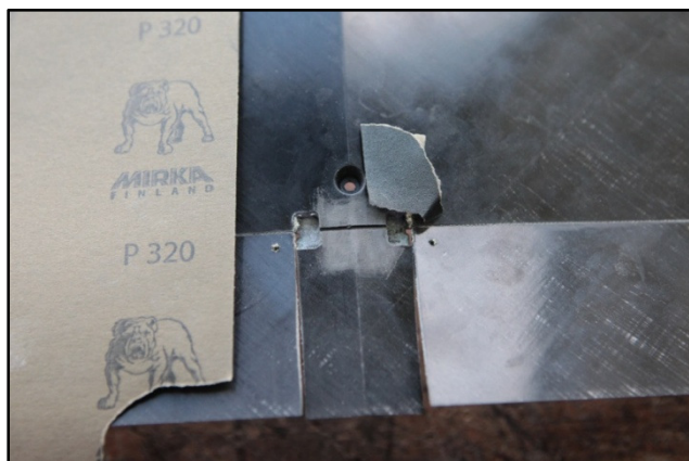
Рис. 2.18 – Зачистка зоны осей наждачной бумагой
