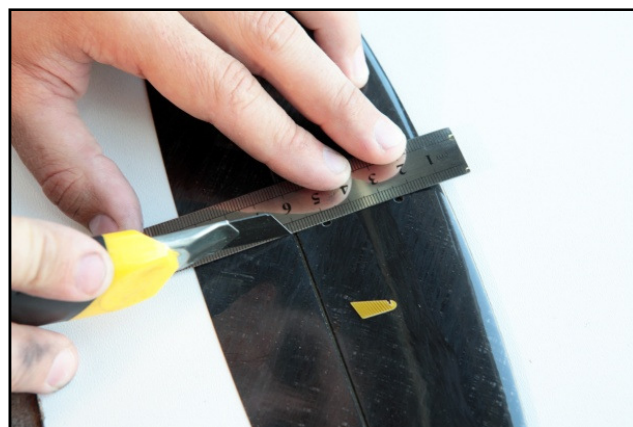
Рис.2.1 – Вклейка кабанчика руля высоты
