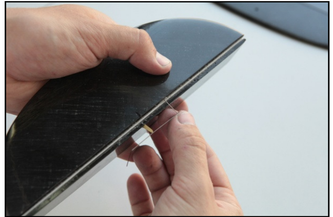
Рис.2.5 – Вставляем торсион в оперение
