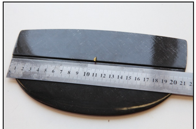
Рис.2.2 – Вклейка кабанчика руля поворота
