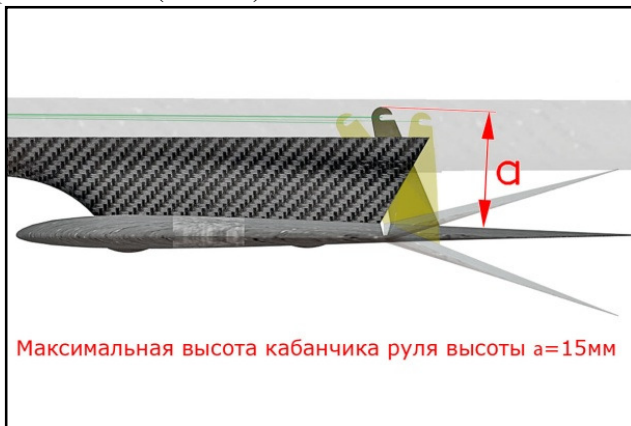
Рис.2.3 – Максимальная высота кабанчика руля высоты
