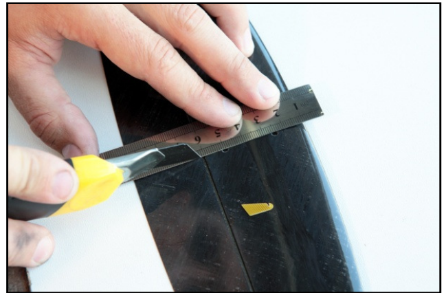
Рис.2.1 – Вклейка кабанчика руля высоты
