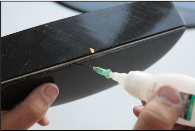
Рис.2.6 – Проклейка торсионов оперения
