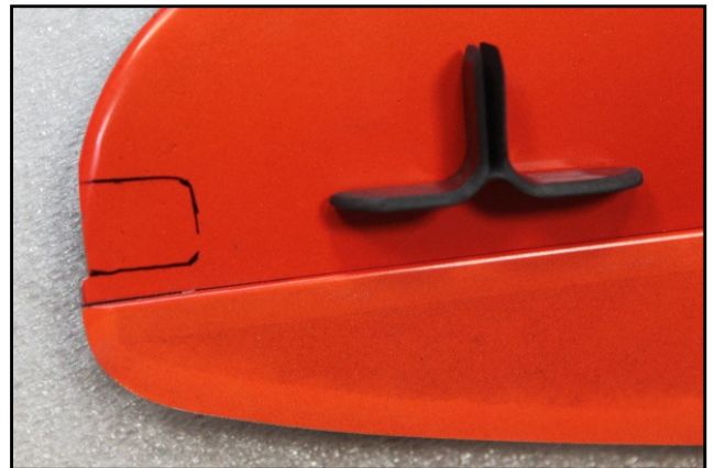
Рис.2.21 – Ровная законцовка для вклейки штыря
