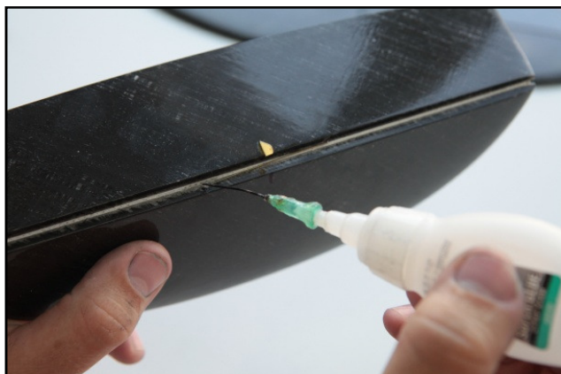
Рис.2.6 – Проклейка торсионов оперения
