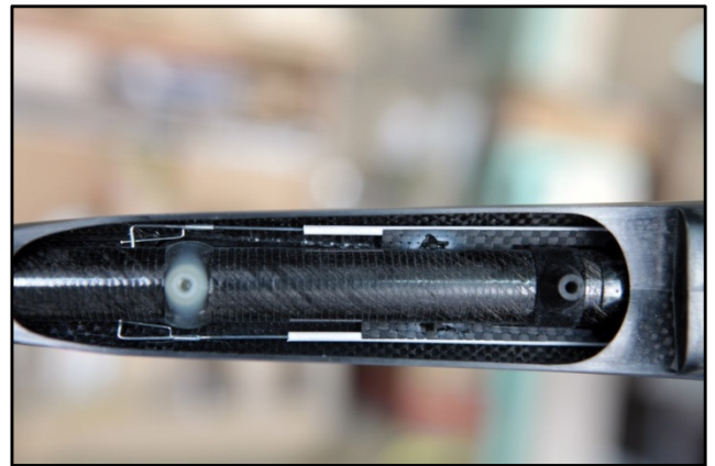
Рис.2.39 – Фиксация тяг элеронов внутри обтекателя
