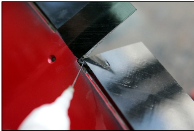
Рис.2.21 –Проклейка кабанчика внутри элерона
