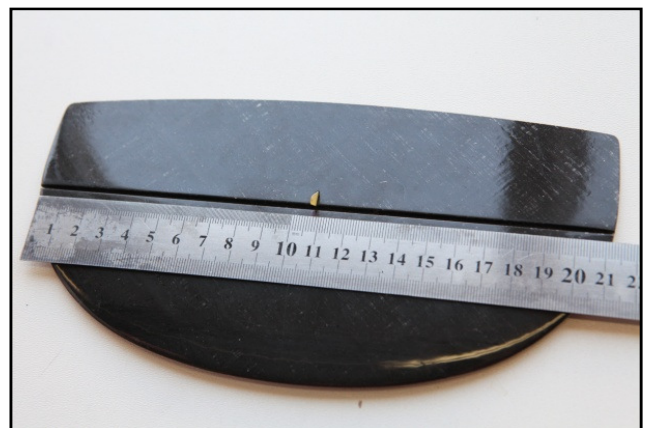
Рис.2.2 – Вклейка кабанчика руля поворота
