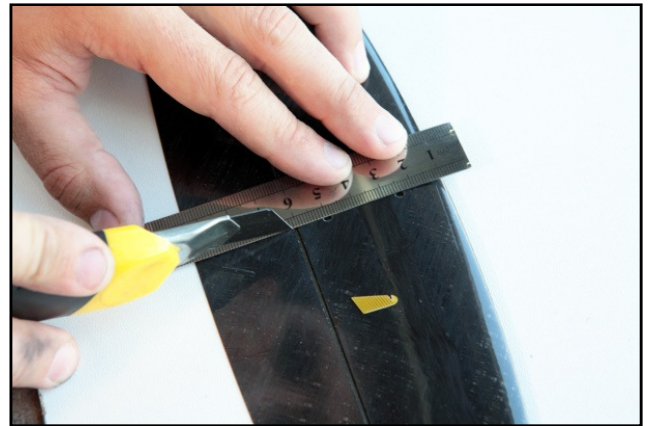
Рис.2.1 – Вклейка кабанчика руля высоты
