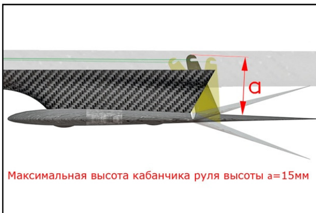
Рис.2.3 – Максимальная высота кабанчика руля высоты
