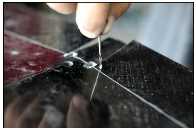
Рис.2.17 – Отверстия для фиксации кабанчика циакрином
